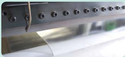
Kontaktloser Auftrag eines Klebstofffilms
