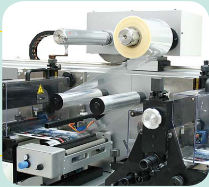
Das Kaltprägewerk ermöglicht die Veredelung von Etiketten
