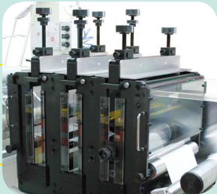
Das LeoMat 3-fach Stanzwerk ermöglicht viele Stanzvariationen
