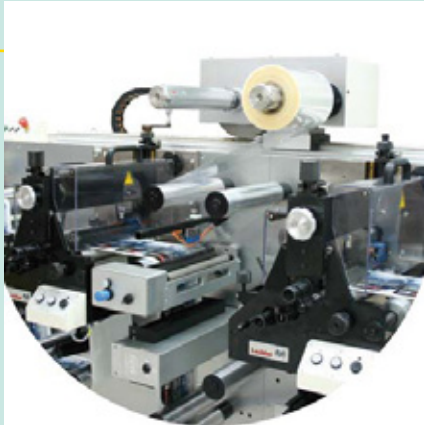
Das Kaltprägwerk ermöglicht die Veredelung von Etiketten.
